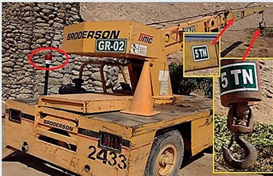
Grúa móvil Broderon de 5 toneladas de capacidad con gancho de izaje equipado con pasador de seguridad operativo, dotada de un dispositivo de sonido operativo que alarma con respecto a su desplazamiento y giro, estacionada en el taller de mantenimiento mecánico y eléctrico.
