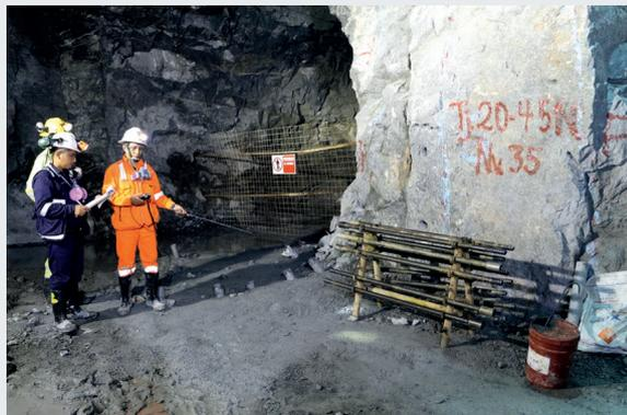
*Se verifica que la velocidad de aire no sea menor de 20 m/min y cuando se emplea ANFO u otros agentes de voladura, la velocidad de aire no sea menor de 25 m/min. Asimismo se verifica la cobertura del requerimiento de aire en las labores mineras.*
