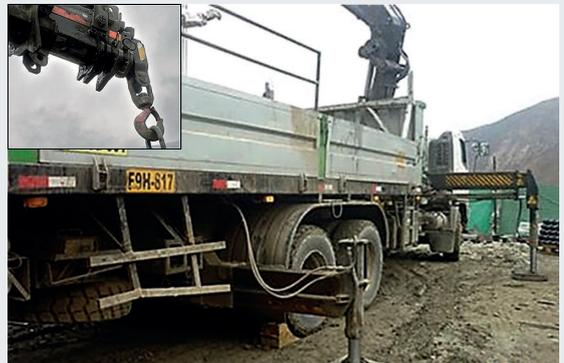
Camión grúa de 15 200 kg de capacidad máxima de izaje, dotada de un dispositivo de sonido que alarma respecto a su desplazamiento o giro, realizando trabajos de izaje en el almacén central.
