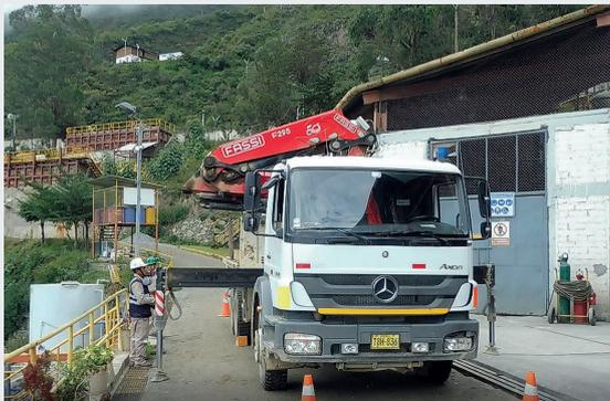
Grúa móvil de 8600 kg de capacidad máxima de izaje, dotada de un dispositivo de sonido que alarma respecto a su desplazamiento o giro, estacionada en la sección de molinda y concentración gravimétrica.
