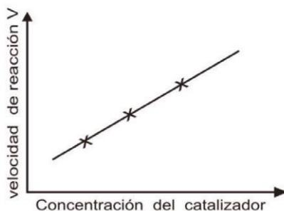
Fig. 11. Influencia de la concentración del catalizador sobre la velocidad de reacción.
