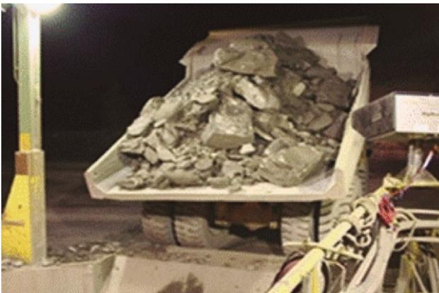
están los minerales, y fracturar o rajar las partículas de mineral que van a ir a la planta. Se debe buscar que maximizar el fracturamiento de la roca a través de la energía explosiva, lo cual reduce la cantidad de trabajo requerido en el chancado tradicional y molienda, además que es más barato usar explosivos para romper las rocas que energía eléctrica en chancado y molienda.
