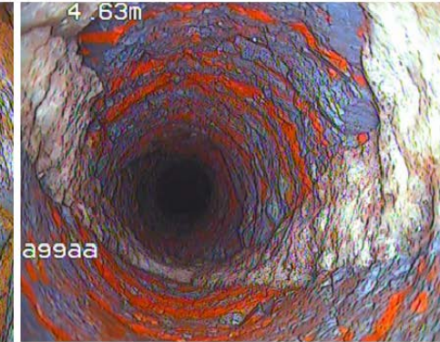
Interior do furo mostrando a ocorrência de estruturas geológicas
