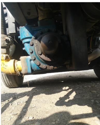
Bomba de despacho de GLP, sin protección en la parte inferior.
