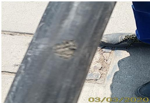
Daños en la cubierta de las mangueras de despacho
