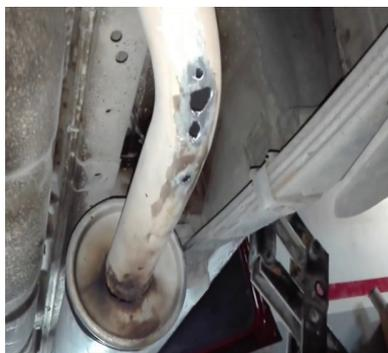
Tubo de escape en mal estado, perforado
