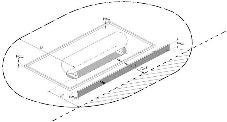
Muro reductor para elementos puntuales
