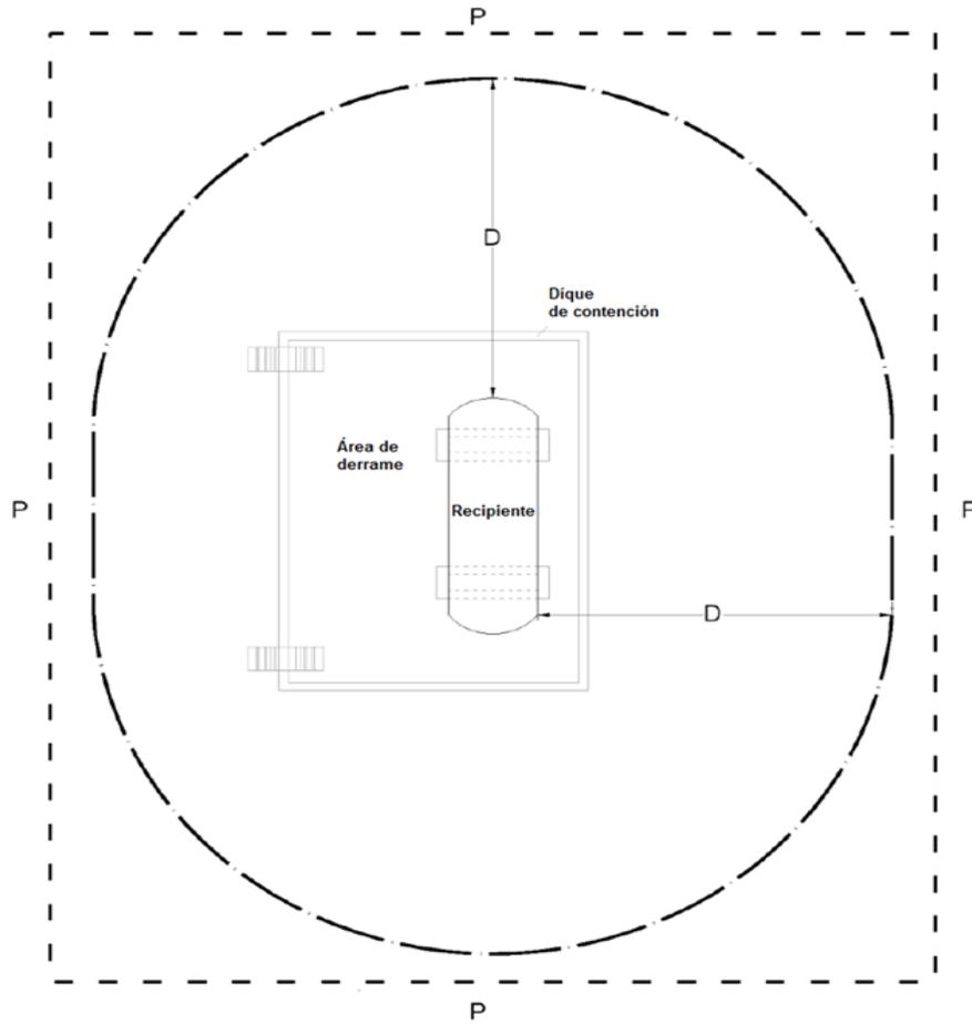
Figura A.2 - Distancia de seguridad. Metodología de medición.
