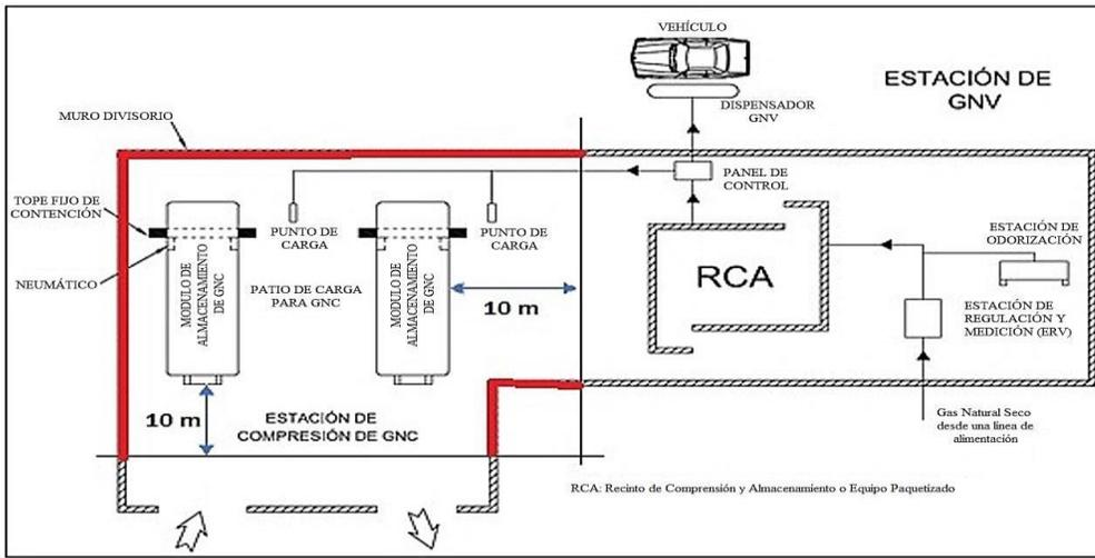
**Figura 1B - Esquema referencial de una estación de compresión compartida con un establecimiento de venta al público de GNV**
