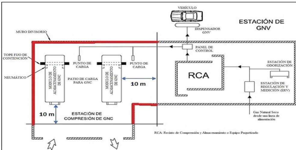
**Figura 1C - Esquema referencial de una estación de compresión**
