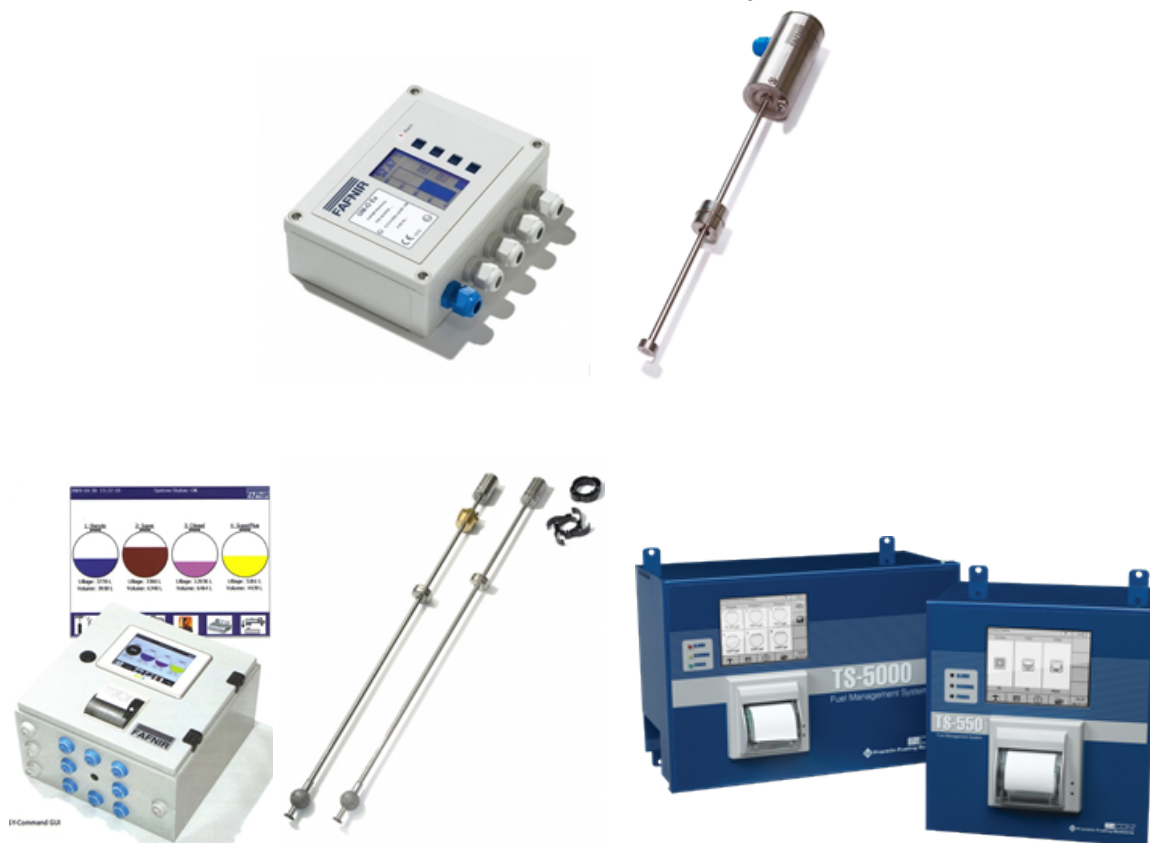
Figura 5: Medidores típicos por telemetría para tanques de GLP: Medidor de Nivel Electrónico que expresa volumen en % y altura en mm (arriba). Medidor Volumétrico Electrónico (ATG) que expresa volumen en Litros/Galones (abajo)
