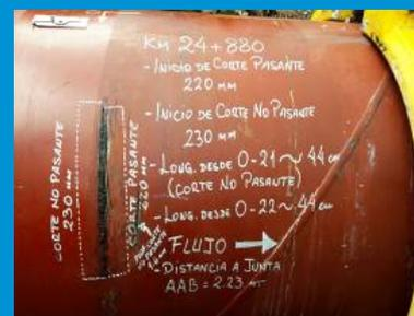
Km.24+880: Corte Pasante de 22cm a 2.23 m de la Junta
