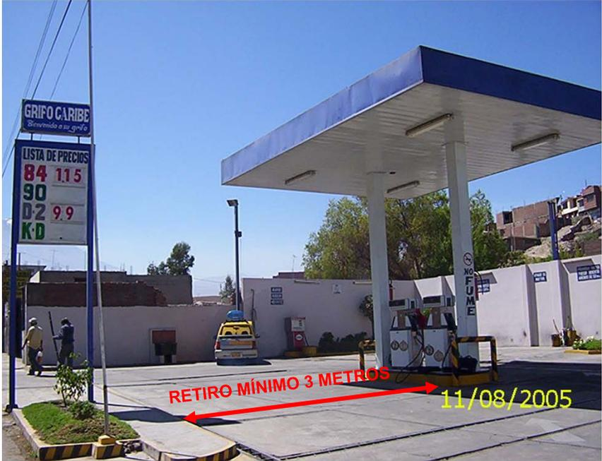
**Debe existir un retiro mínimo entre la isla de despacho y el borde interior de la vereda. dicho retiro debe ser de 3 metros como mínimo y se medirá del borde más cercano de la isla del surtidor y/o dispensador hasta el borde interior de la vereda**
