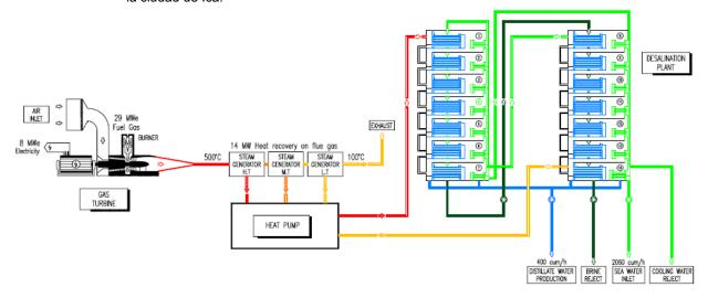
Figura Nº 01. Planta dual MED acoplada a una turbina de gas ciclo simple [2]
