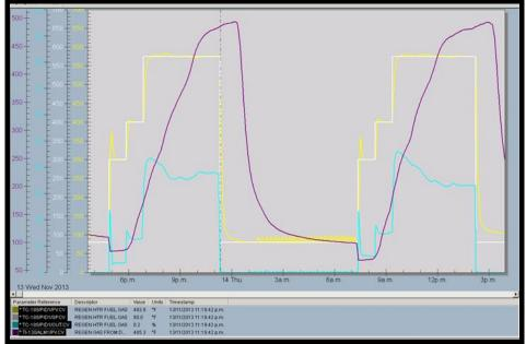
Figura Nº 6. Gráfica actual de una regeneración con rampa en Planta PGP
