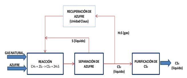
Figura N° 03. Diagrama de bloque para la fabricación de CS2 a partir de gas natural
