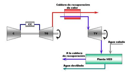
Figura Nº 02. Planta desalinizadora MED acoplada a una central de ciclo combinado gas - vapor
