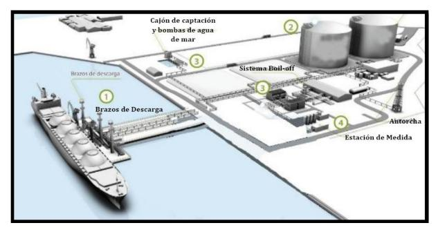
Figura 1. Planta típica de regasificación de gas natural. Fuente: Enagas
