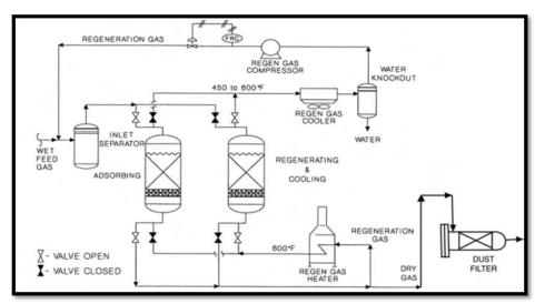
Figura N° 2. Representación del Sistema de Deshidratación
