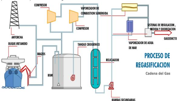
Fig. 8. Diagrama de flujo propuesto para planta de regasificación de GNL. Fuente: SAGGAS
