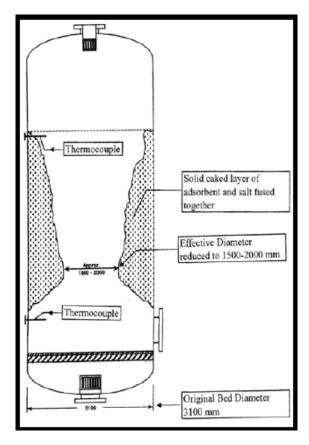
Figura N° 3. Representación del avance formación de costra en el Deshidratador (Tamiz Molecular gastado)
