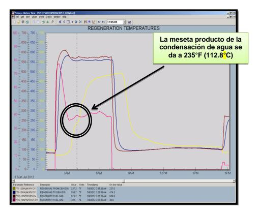
Figura Nº 5. Gráfica típica de una regeneración sin rampa en Planta PGP
