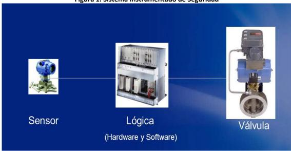
Figura 1. Sistema Instrumentado de Seguridad
