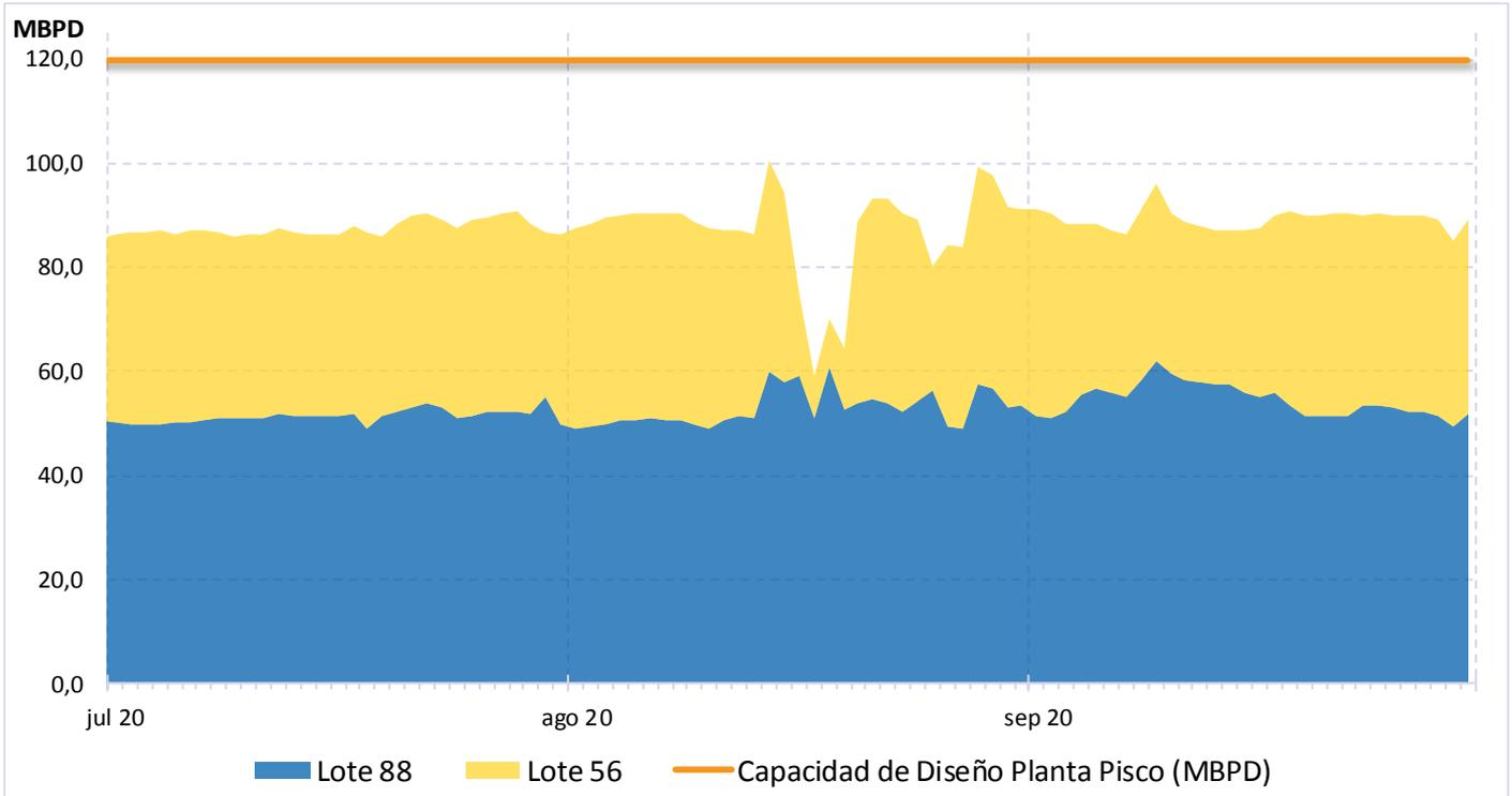
Gráfico 20. Gas Natural Procesado por Lotes y capacidad de Diseño de Planta Pisco (en MBPD)
