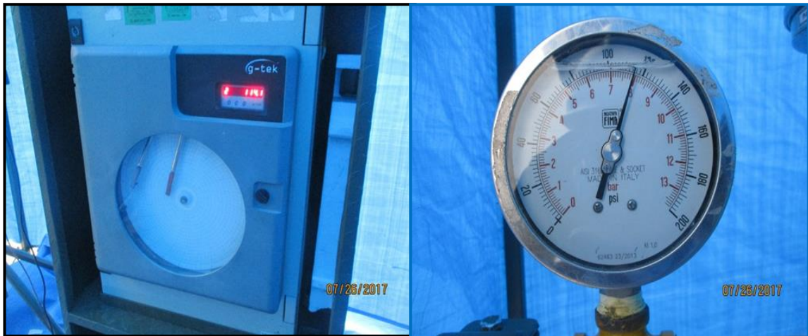
Foto 7.- Redes Tacna: Verificación de pruebas en redes de distribución, temperatura y presión en manotermógrafo. Prueba de hermeticidad.
