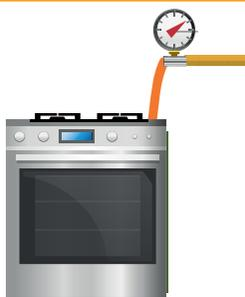
La prueba consiste en hacer pasar gas natural y encender los artefactos para luego medir la presión con un manómetro. La medida debe estar en el rango de 18 a 23 mbar.
