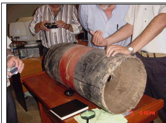
Imagen 10: Inspección visual de la junta y del metal base de la tubería, realizada por AH Inspectweld NTD.
