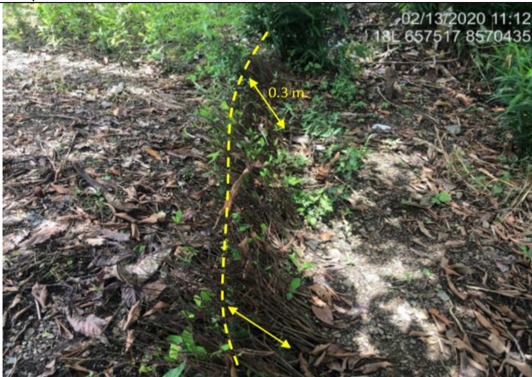
Figura 05: Verificación de hundimiento de terreno formando un escarpe con una altura aproximada de 30 cm, ubicada al lado derecho del ducto de GN
