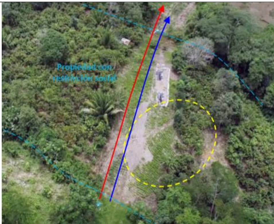
Figura 05: Verificación de hundimiento de terreno formando un escarpe con una altura aproximada de 30 cm, ubicada al lado derecho del ducto de GN
