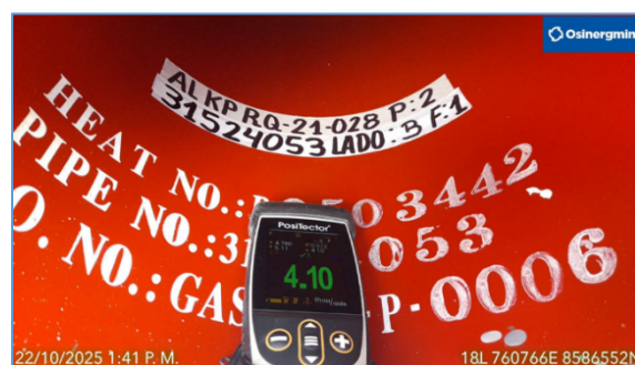
Área 3: Acopio KP-RQ-21-028 Echarati. Verificación del estado del revestimiento interno de la tubería.
