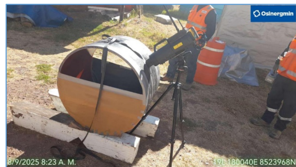
Área 4: Acopio Calca. Vista del equipo de radiografía digital y niple de 32" para la prueba de dicho equipo.
