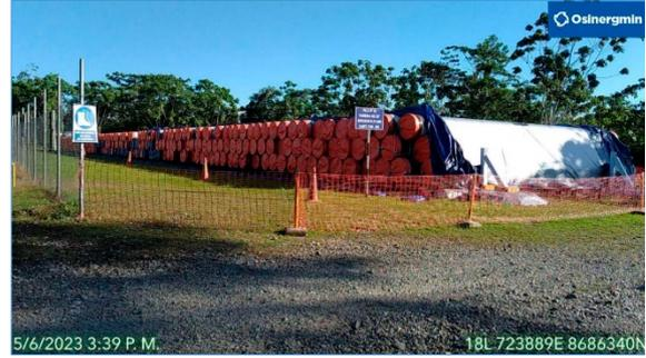
**Área 1:** Acopio Ticumpinia. La tubería cuenta con cobertura de lona, y los extremos de las tuberías tapados.
