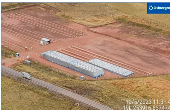
**Área 4:** Vista aérea del Acopio de Espinar. Se aprecia las pilas de tubos cubiertos con lona para protección contra los rayos UV.
