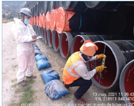
• **Medición de espesores por ultrasonido en uniones soldadas.**
