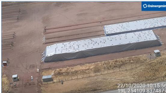
**Área 4 - Acopio de Espinar (Vista aérea).** Tubería cubierta con lonas para la protección de rayos UV
