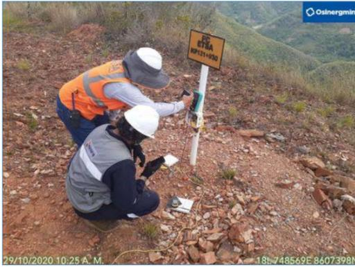
**Área 3 – DDV KP 131+930:** Vista de la medición del potencial INSTANT OFF Y ON de la tubería de 32". (KP 131+930)
