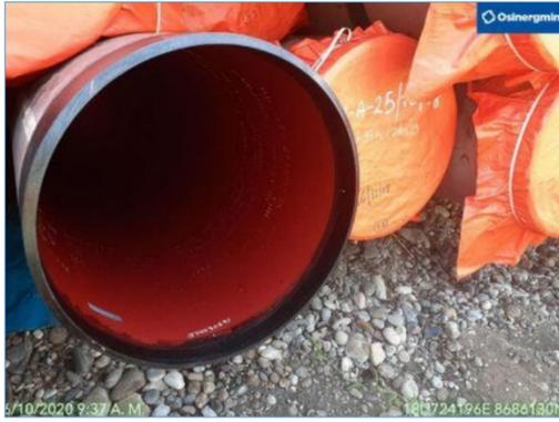
**Área 1 – Acopio KP 04.** Tubería acopiada. Vista de la parte interna de la tubería de 32” de la pila N° 3, se aprecia la limpieza interna, la cual está en buen estado.
