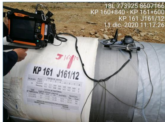
• **Medición de la dureza del revestimiento.**
