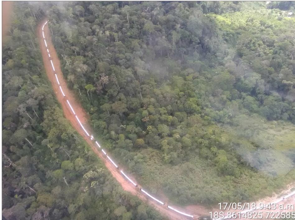
Vista aérea del KP 95. Se aprecia tubería soldada, pintada, desplegada sobre el DDV.
