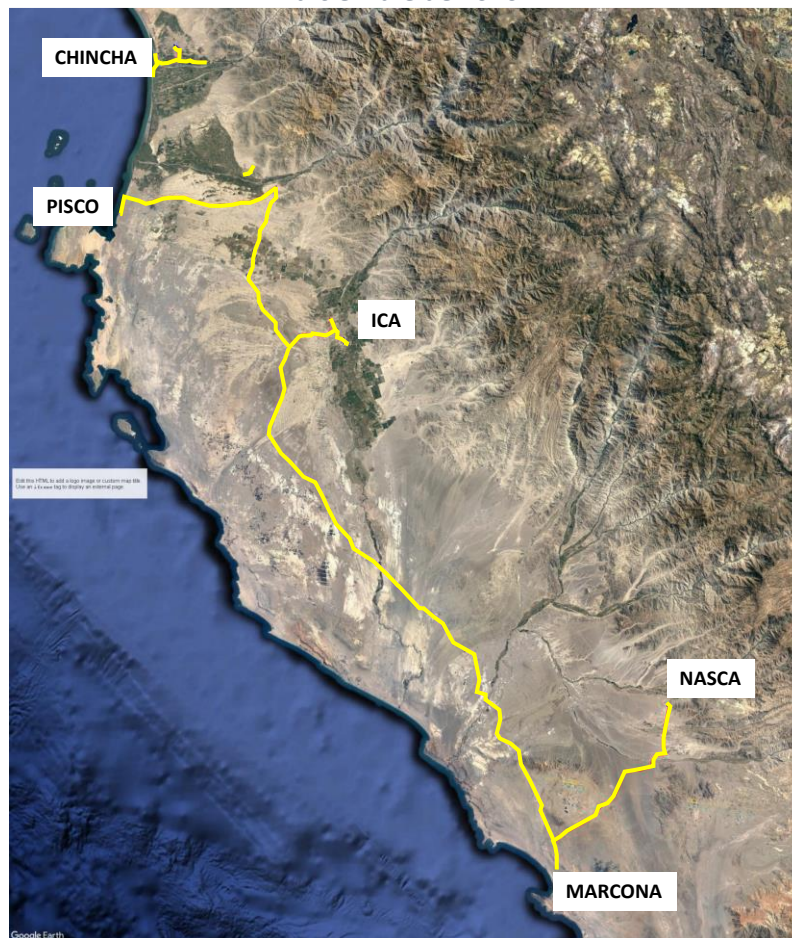
Gráfico 85: Sistema de Distribución de gas natural de ICA – infraestructura en Red de Acero a diciembre de 2020
