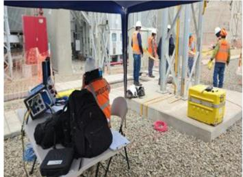
Prueba de tensión, toque y paso - S.E Planicie
