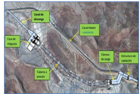
Obras que integran el proyecto
