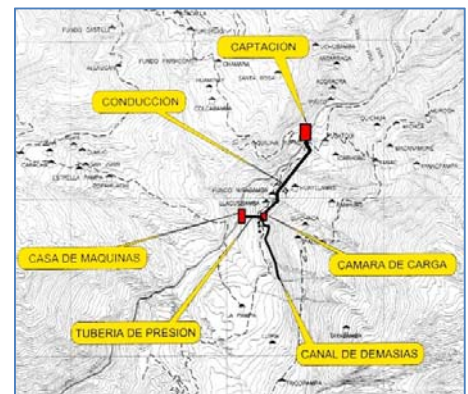
Captación – Casa de Máquinas
