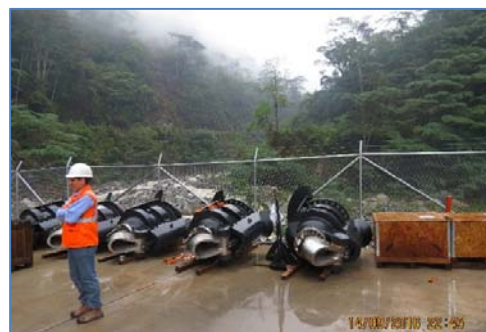
Inyectores de la turbina
