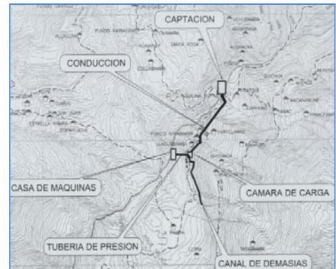
Captación-Casa de Máquinas
