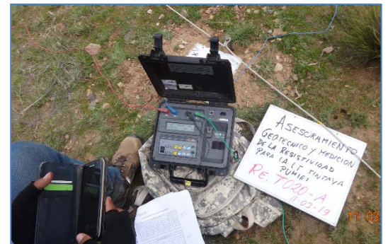
Medición de resistividad
