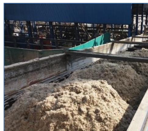
Bagazo triturado para uso de combustible
