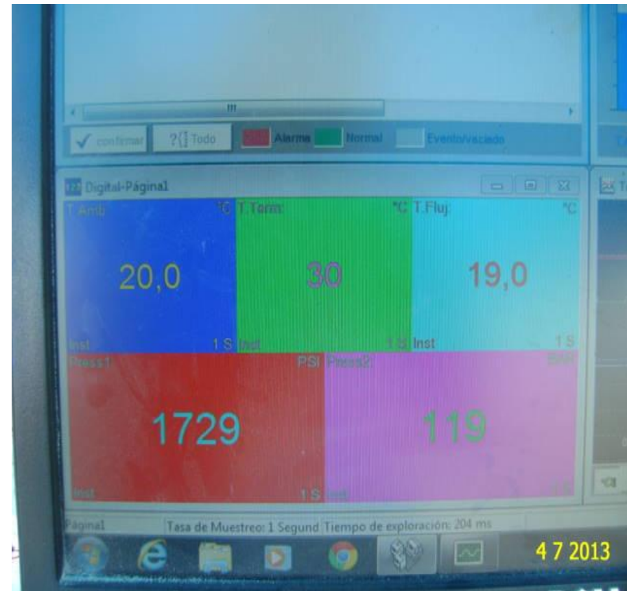
Datos de la prueba hidrostática (Pantalla de digitalizador)
