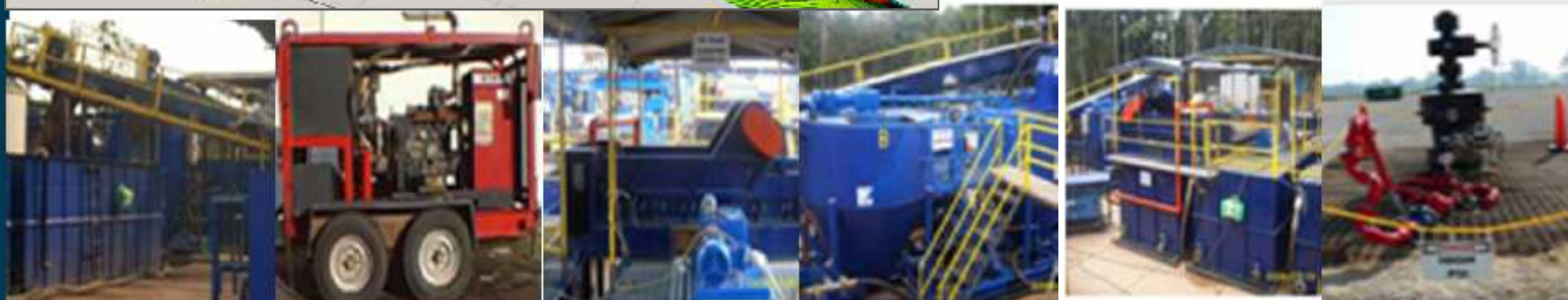
Reinyección de cortes de perforación
