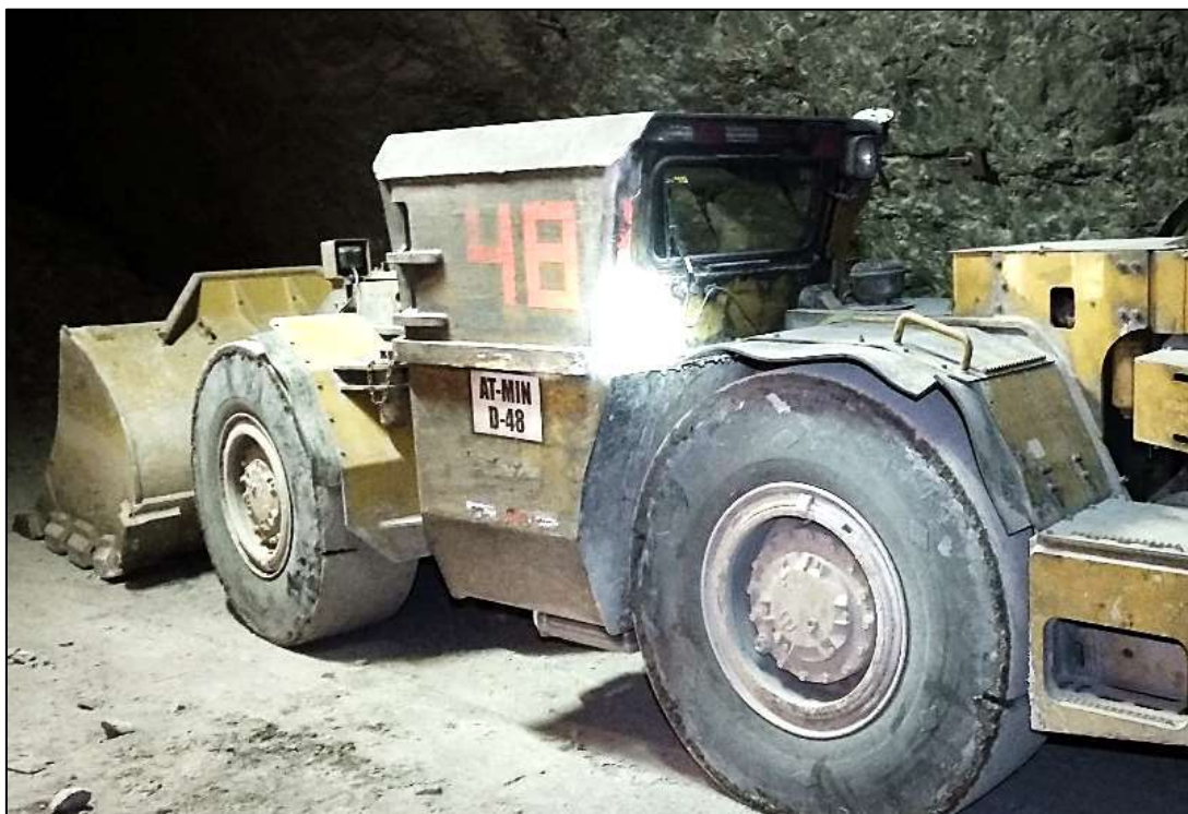
Equipo scooptram con protector guarda cabezas sólido ante la posible caída de rocas
