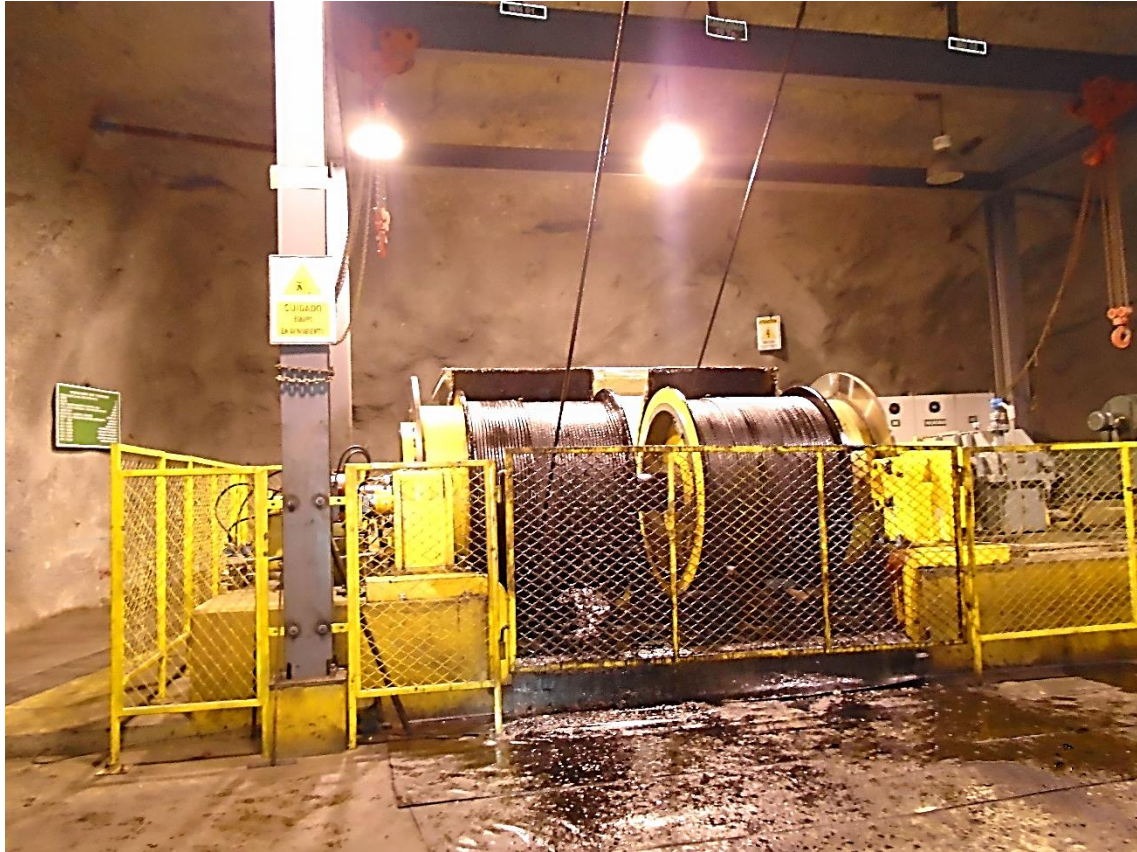
Winche Hepburn del pique 740 de Austria Duvaz, de doble tambora y con cable de acero de 1"
