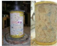
Figura 10. Probeta obtenida a partir de la muestra en bloque, antes y después de compactar.
