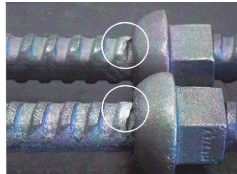
Detalle del efecto en los resalte debido al ensayo de tracción en el conjunto barra-tuerca
