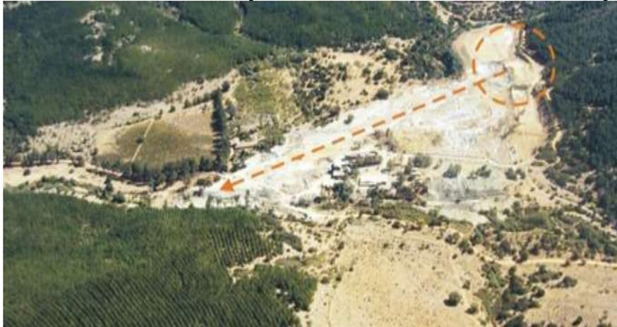
Causas: Licuación sísmica a nivel basal en muro resistente y de la cubeta del embalse, por saturación generada por runa vertiente no detectada.
