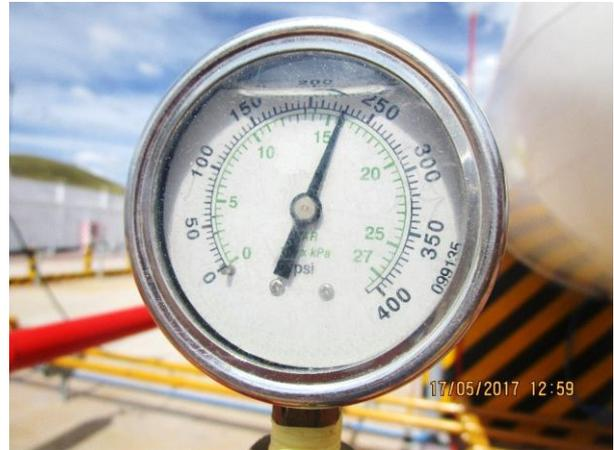
*Manómetro al final de la prueba de hermeticidad de tuberías del sistema contra incendio, se registró una presión de 228 psig.*
