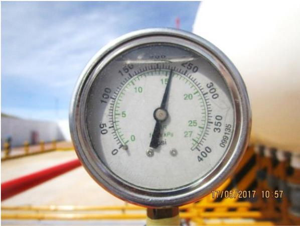
*Manómetro al inicio de la prueba de hermeticidad de tuberías del sistema contra incendio, con una presión de 225 psig.*
