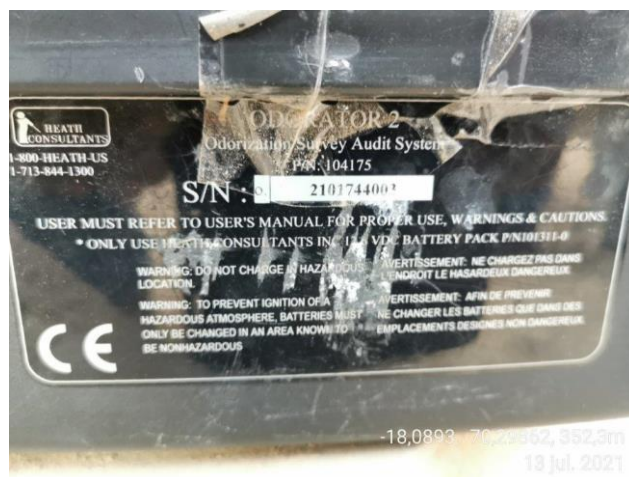
ODORIZACION TACNA: Verificando la vigencia de calibración de equipo ODORATOR 2 con serie N° 2101744003.
