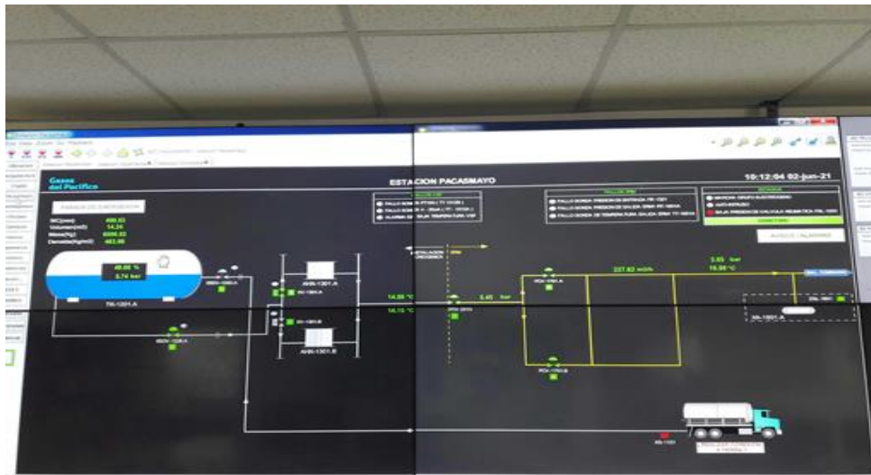
Foto 18.- Control Operativo de ED Pacasmayo. Capacidad m3 de GNL: Tk N1: 14.24 m3.
