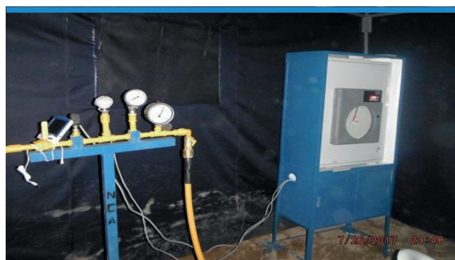
Redes Arequipa: Verificación de pruebas de hermeticidad usando manotermógrafo.
