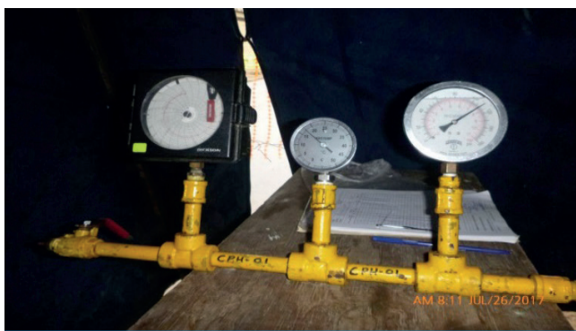
Prueba de resistencia y hermeticidad, Proyecto Extensión de Red a Macchu Picchu Food, distrito y provincia de Pisco.
