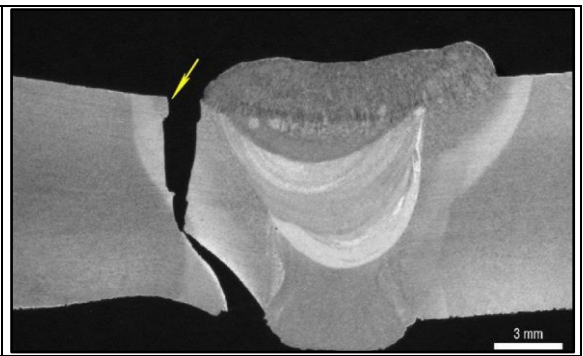
Imagen 22: Macrografía cross section de la fractura.
