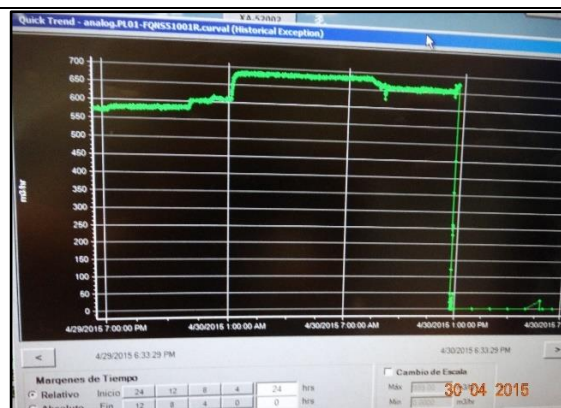
Imagen 12: Vista de la tendencia del flujo de transporte de LGN reportado por el SCADA. El gráfico muestra que el flujo cesó aprox. a las 12:40 horas, coincidente con lo manifestado por TGP. (30.04.2015)
