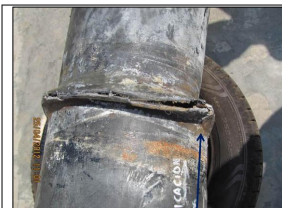
Imagen 20: Vista de la arruga sobre soldadura circunferencial. (25.04.2014)
