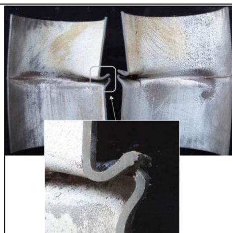
Imagen 14: Vista de las dimensiones de la fisura.
