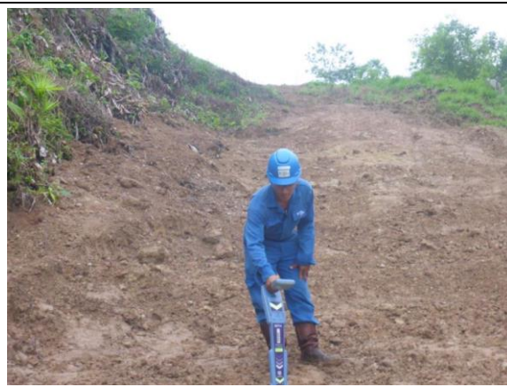
Imagen 15: Vista de la medición del nivel de tapada por parte del personal de Aguaytia Energy en el KP 40+000 del ducto de 10” de GN (Fuente Aguaytia)
