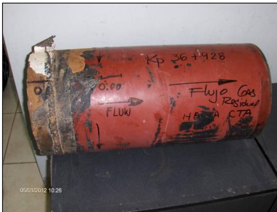
FOTO N° 08: Muestra de tubo aguas abajo de la falla (58 cm de longitud), La dirección del flujo se indica de izquierda (Neshuya) a derecha (CTA).
