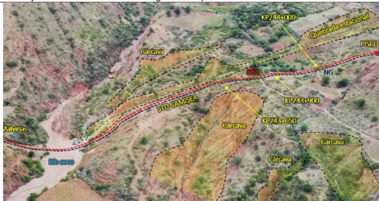
Figura 02: Vista Panorámica del Derecho de Vía (DdV) en el sector de la condición de riesgo en el KP 243+900, con procesos erosivos presentes con grietas y asentamiento transversal al DdV, en suelos arenosos y limo arcillosos. Fuente: (Plan de trabajo remediación geotécnica -COG-001-MTGEPR-019-0-19_KP244+000)
