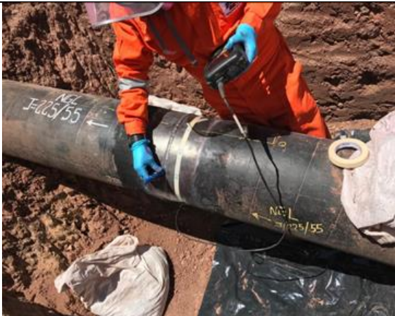
Figura 04: KP 244+100 – Ensayo no destructivos – medición de espesores y revestimiento de cortacorrientes y canal colector en el KP 243+600. Fuente: TGP
