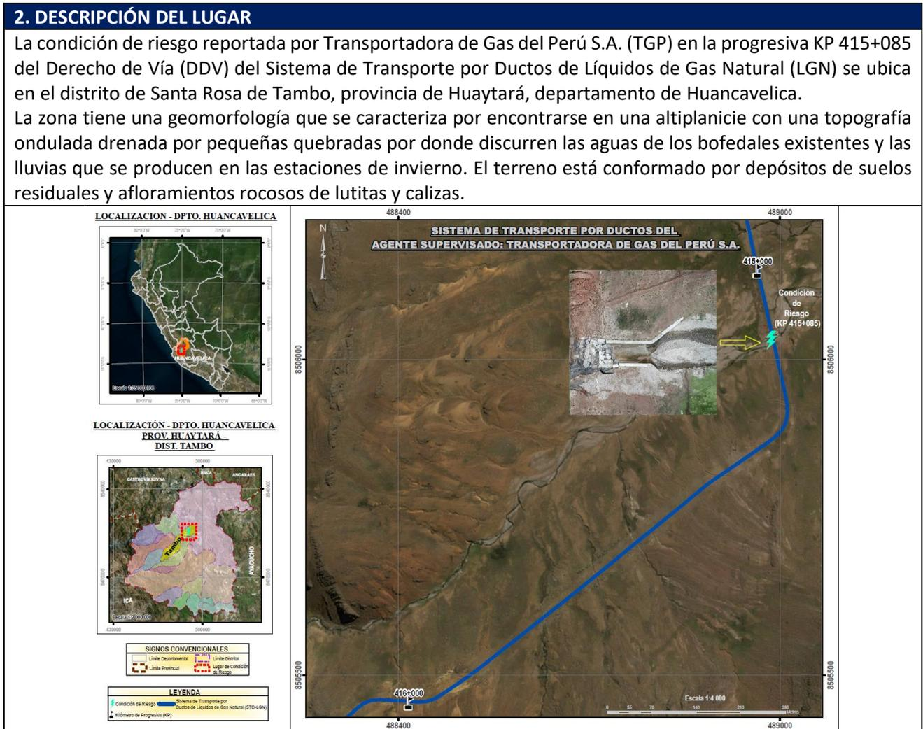
**Figura 01:** Vista satelital y de dron de la ubicación de la zona donde se detectó la condición de riesgo en el ducto de transporte de LGN.
