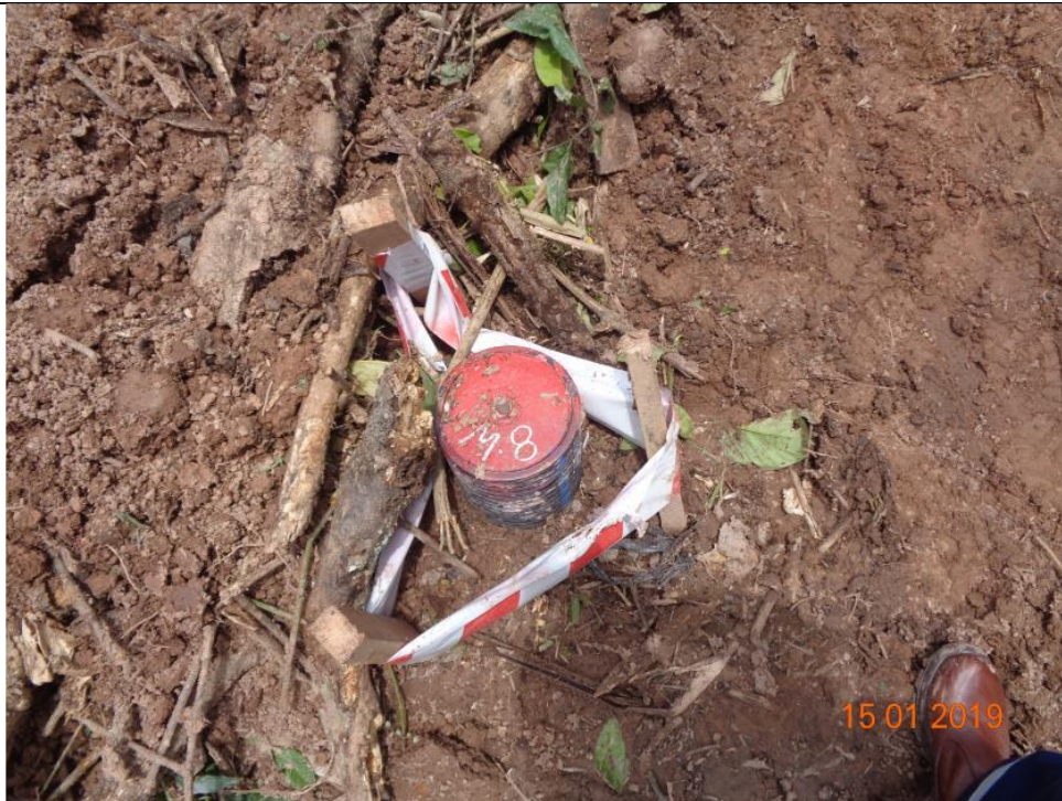
Figura 10: KP-8+400 del DDV de TGP / (WGS84, 18L 725289E 8681796N). Lado derecho del DDV, se aprecia instalación de punto de monitoreo topográfico del terreno, ubicado próximo al borde del lado derecho del DDV (fuente IS-0001003247-CEG-JAB).
