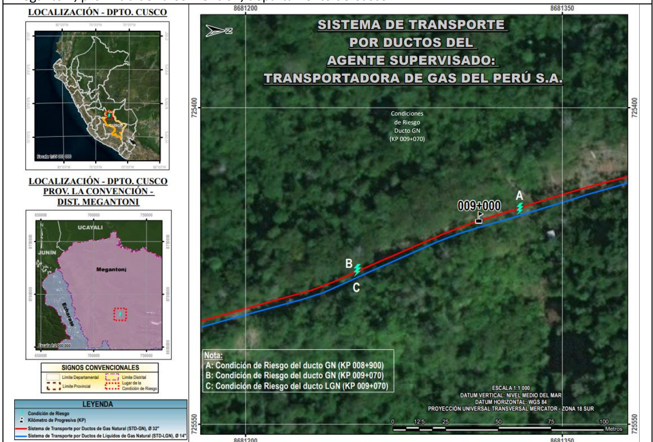
Figura 01: Vista satelital de la ubicación de la zona donde se detectó las 3 condiciones de riesgo: KP 009+070 (GN y LGN) y KP 008+900 (GN).
