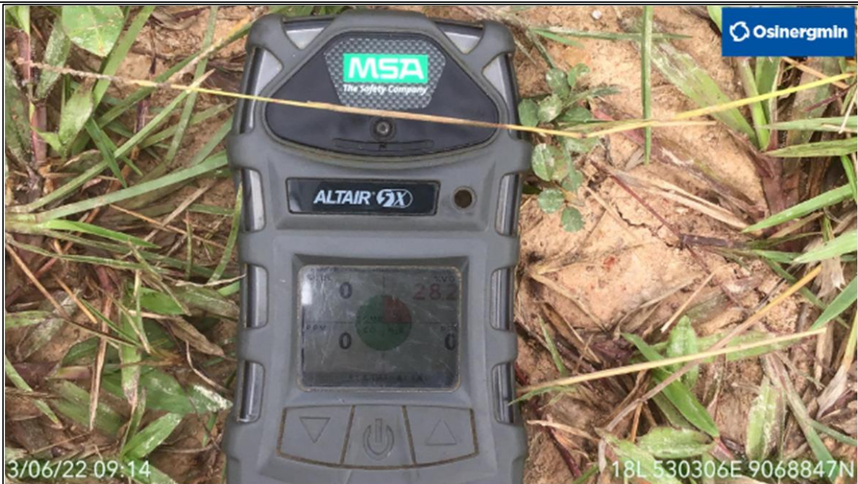
Figura 10: Verificación de nivel de explosividad, se verifica LEL 0%
