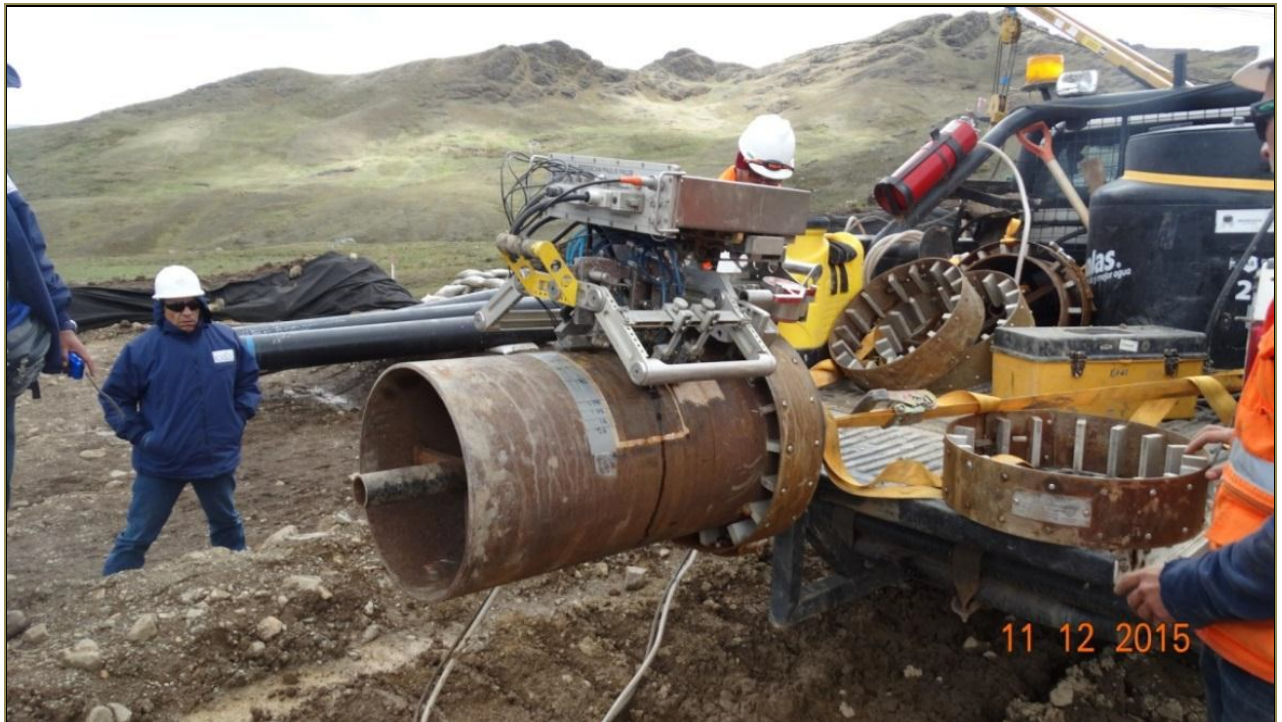
Calibración del Equipo para realizar la prueba de ultrasonido a las juntas soldadas.
