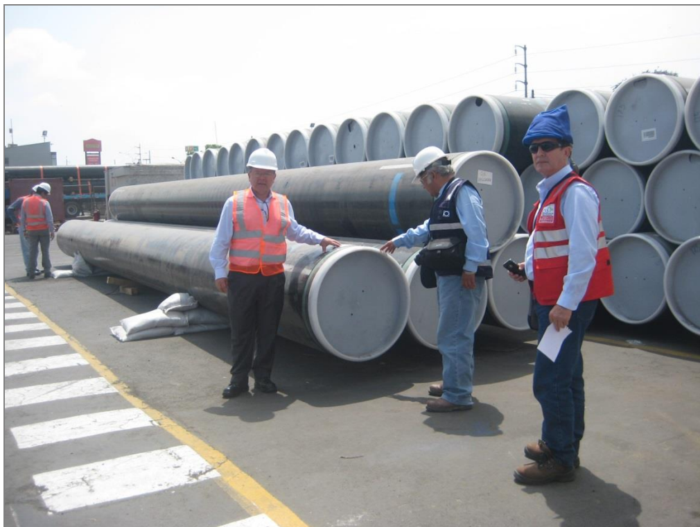
Foto-02: Supervisor de Osinergmin, Ing. Luis Dediós inspeccionando la tubería de 32"Ø, de 17.5 mm de espesor (la franja azul señalada por la flecha indica la clasificación de la tubería según su espesor), el protector de la tubería es de polipropileno.
